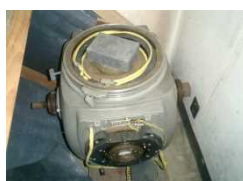
しゃへい体 (劣化ウラン)
